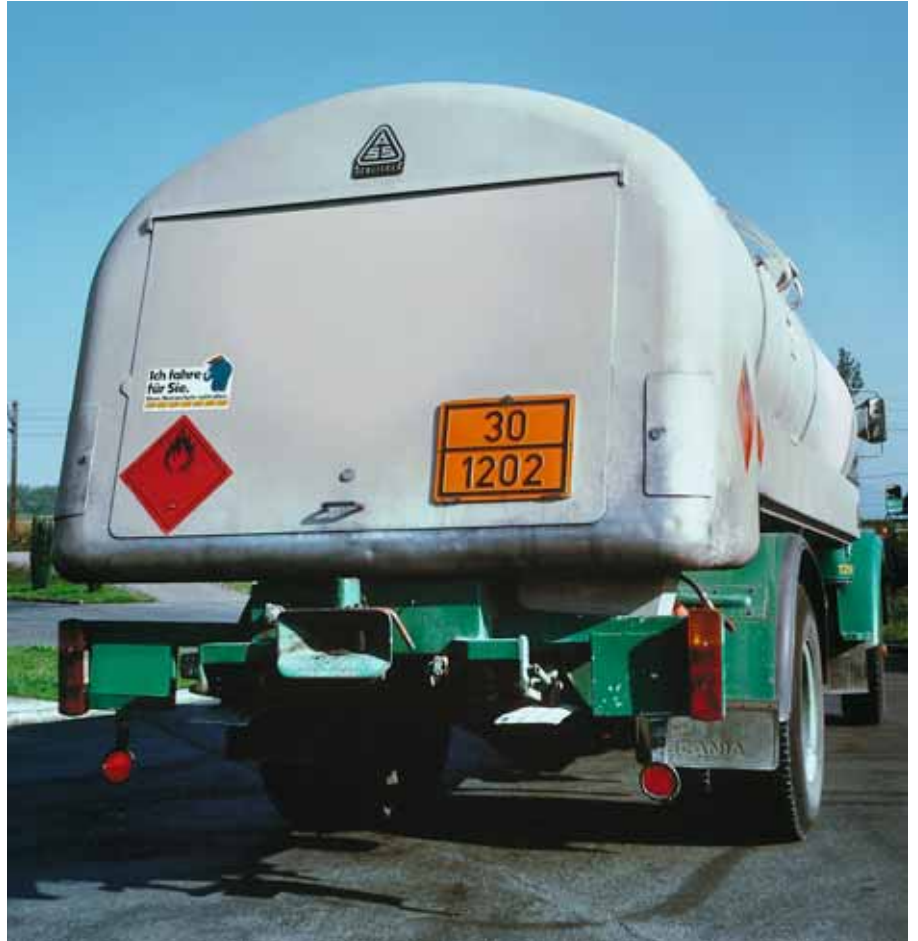
Bild 31 Fahrzeug, mit dem der entzündbare flüssige Stoff Heizöl transportiert wird. Die Zahl 3 im oberen Feld der orangen UNO-Tafel weist darauf hin, dass das Transportgut brennbar ist. Mit der Zahl 1202 im untern Feld wird zum Ausdruck gebracht, dass Heizöl transportiert wird.
