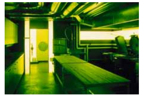
Bild 30 Raumbeleuchtung durch nachleuchtende Farben.
