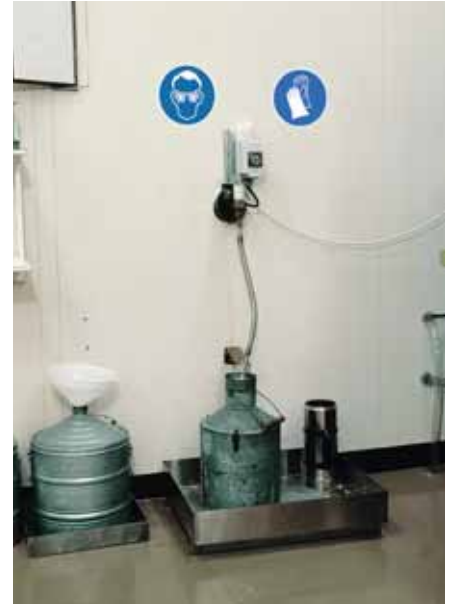
Bild 23 Arbeitsplatz, an dem mit ätzenden Flüssigkeiten hantiert werden muss. Mit den beiden Gebotszeichen wird das Tragen von Schutzbrillen und Schutzhandschuhen vorgeschrieben.
